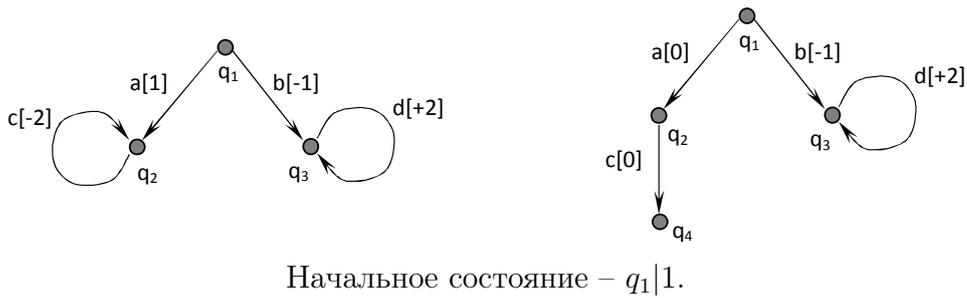
Рис. 5. Неправильно (слева) и правильно (справа) организованные односчетчиковые сети, порождающие один и тот же язык
