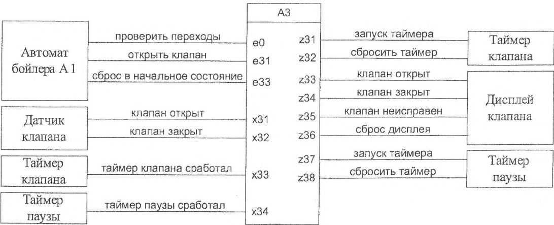
Рис. 6. Схемы связей и графы переходов автоматов управления нагревателем А2 и клапаном А3
